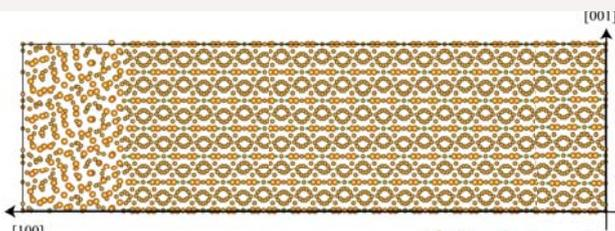
図 1: 全 8463 原子からなる、Nd<sub>2</sub>Fe<sub>14</sub>B / アモルファス Nd-Fe 相の原子構造。方位は主相の結晶方位をあらわす。
