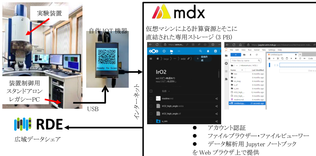
図 1: ARIM-mdx システム概略図。利用者の許可を得て公開可能となったデータは NIMS-RDE に送られシェアされる。実験装置からクラウドシステムへは、IOT 機器を介してファイルを一方通行で送るのみ許可しており、外部から実験装置 PC を攻撃されないように設計されている。実験装置 PC からは USB フラッシュメモリとして認識される IOT 機器は、実体としてはネット接続された Raspberry Pi である。
